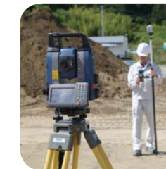
緑が見えたら右へ 赤が見えたら左へ 測設ライン
